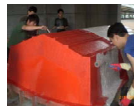
圖 11 船殼 FRP 母模積層
