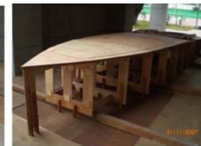
圖 2 甲板封板製作組裝
