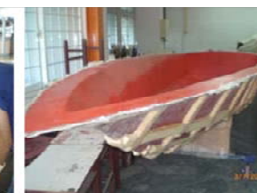
圖 12 船殼 FRP 母模完成
