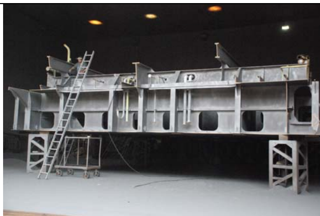
已噴好鋼珠砂的 block，技術頂級
