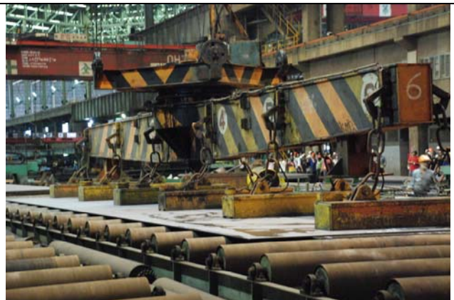
用電磁鐵搬運鋼板
