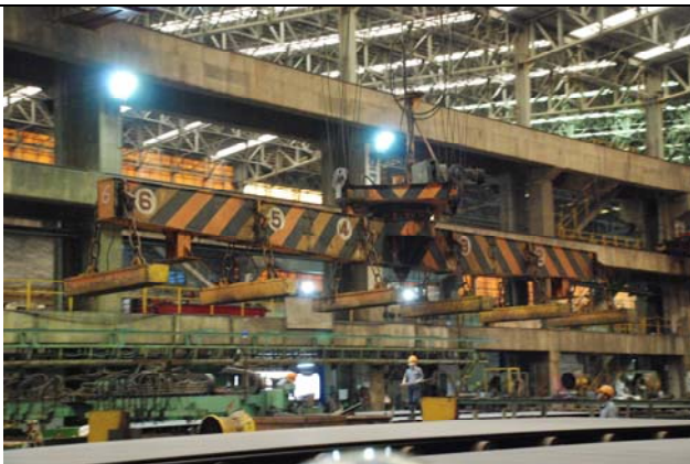
用電磁鐵搬運鋼板
