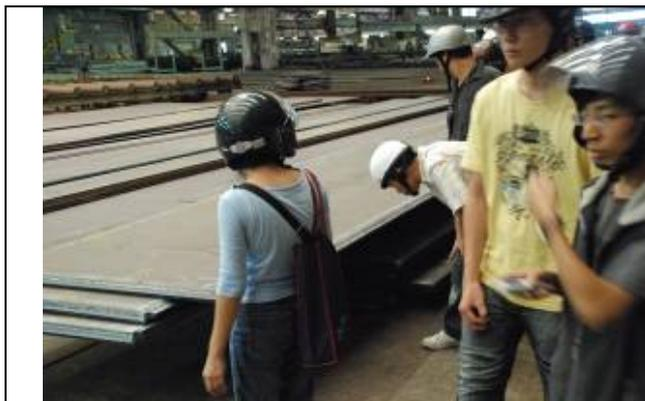
厚達 6cm 的高張力鋼板邊緣開槽
