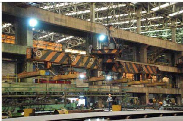
用電磁鐵搬運鋼板
