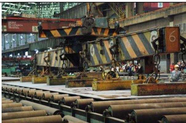
用電磁鐵搬運鋼板
