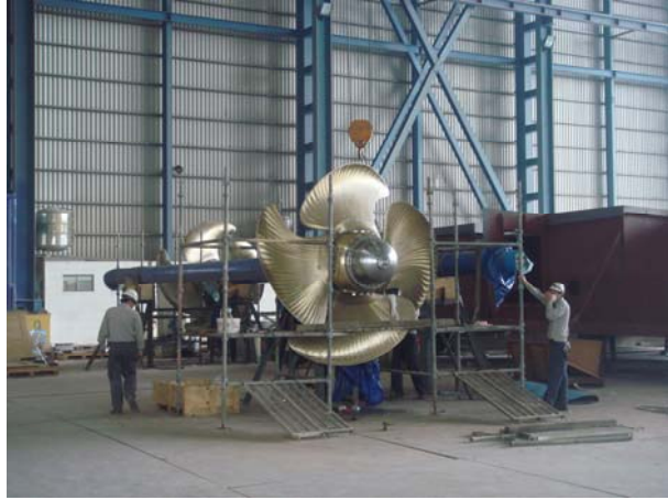
海巡署巡防艦用的推進螺槳，此螺槳徑距為可調整型。
