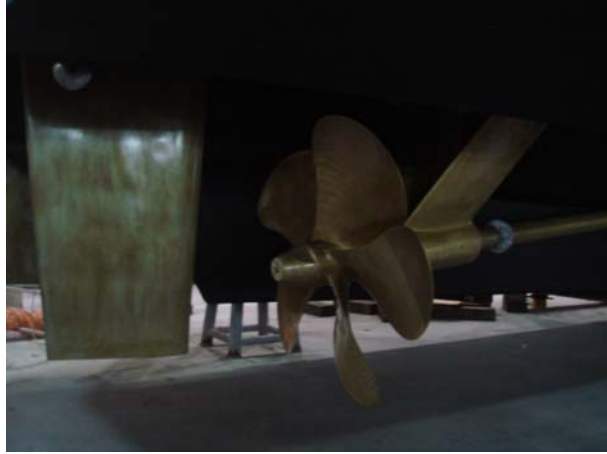
船舵，螺槳，及 V 架和軸管，是調螺槳推進系統。
