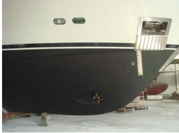
船艙，圖中小螺旋槳為艙側推進器。
