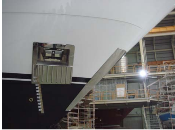
錨鍊及前板破水加強結構之不銹鋼板。
