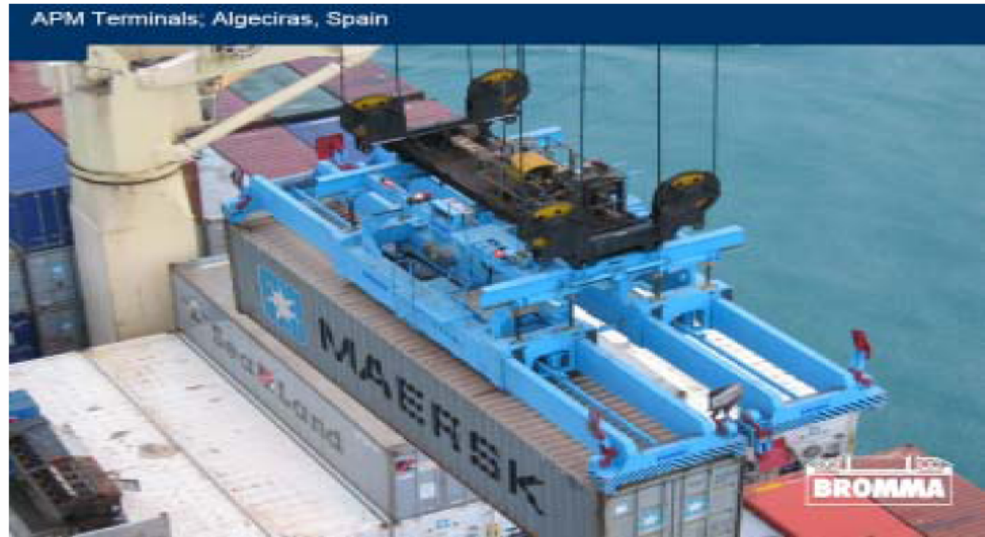
APM Terminal의 Tandem twin-lift 스프레더
