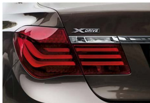
圖 1 LED 導光柱車尾燈[6]
