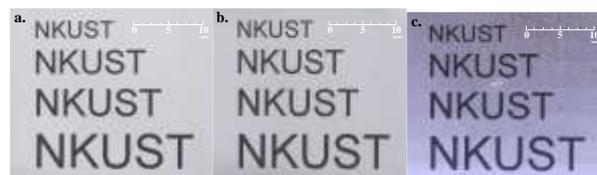
圖 18 前光模組原型測試(a)未加入導光板(b)加入導光板(c)加入導光板並開啟 LEDs
