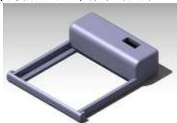
圖 17 導光板的框架設計
