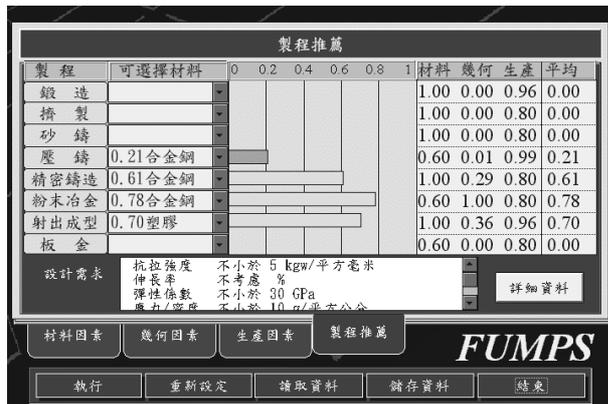
圖 23 搖臂設計修改後的製程推薦
