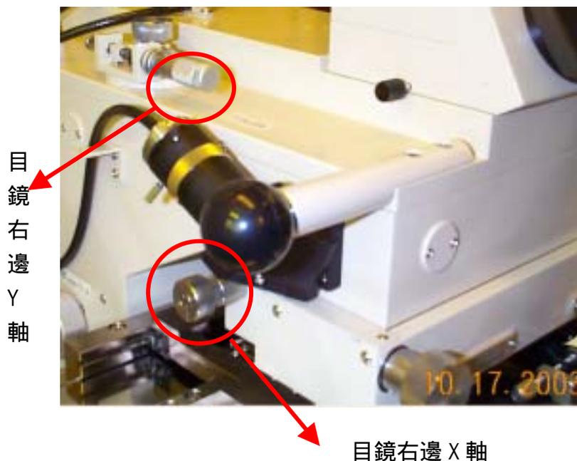
(12) 手動調整 Wafer Stage 的 X.Y.θ 作 Alignment，直到與 MASK 的 PATTERN 對準，各軸旋鈕位置如下圖。
