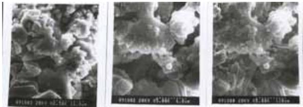
圖 5 石膏—C<sub>3</sub>A 系統水化 30 分鐘後之 SEM 圖
