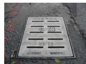
水 23 第二次檢查-正面 (12.27) 不飽和聚脂複合材料 (大)
