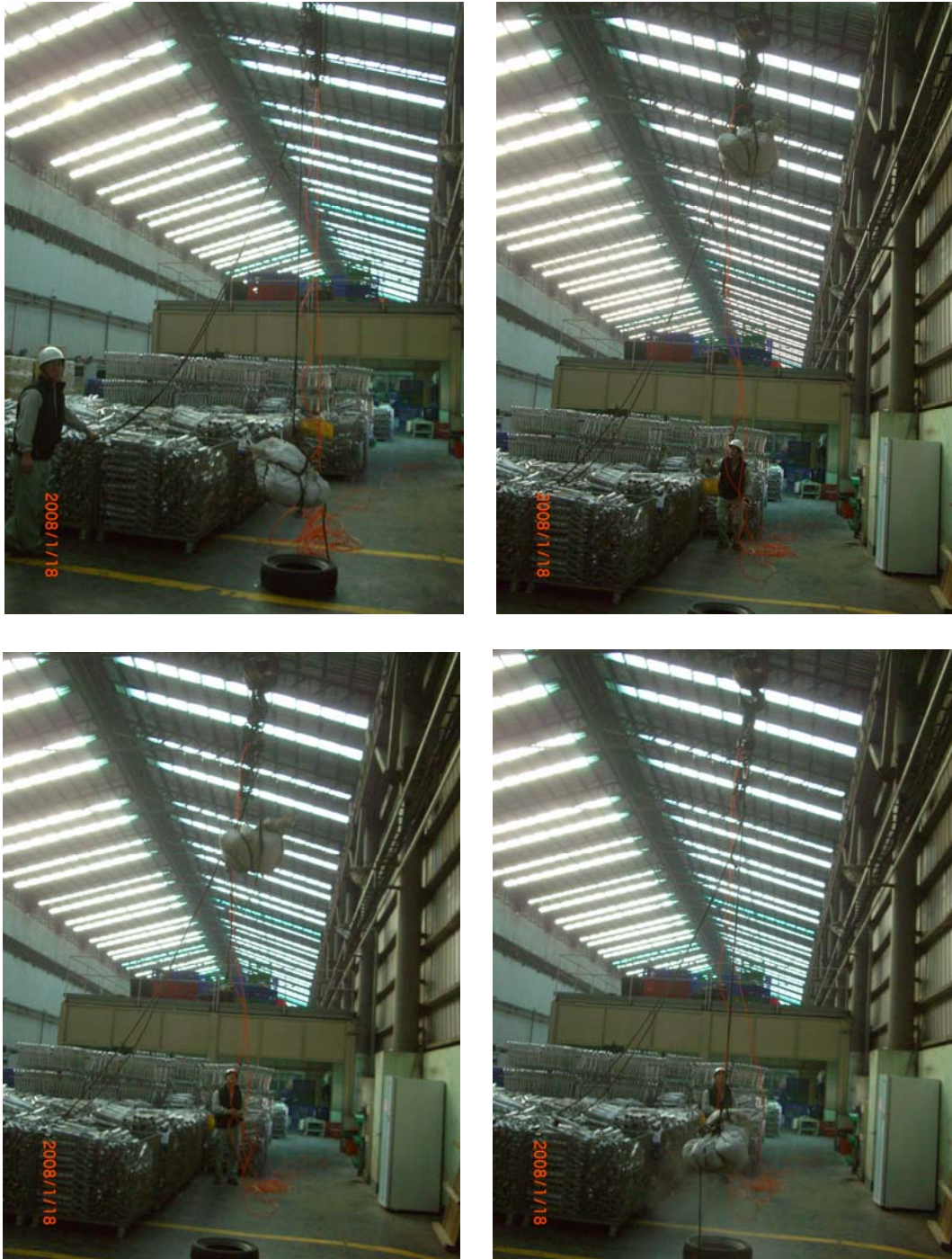
圖 8 掛鈎以 75 kg 砂袋進行自由落下試驗
