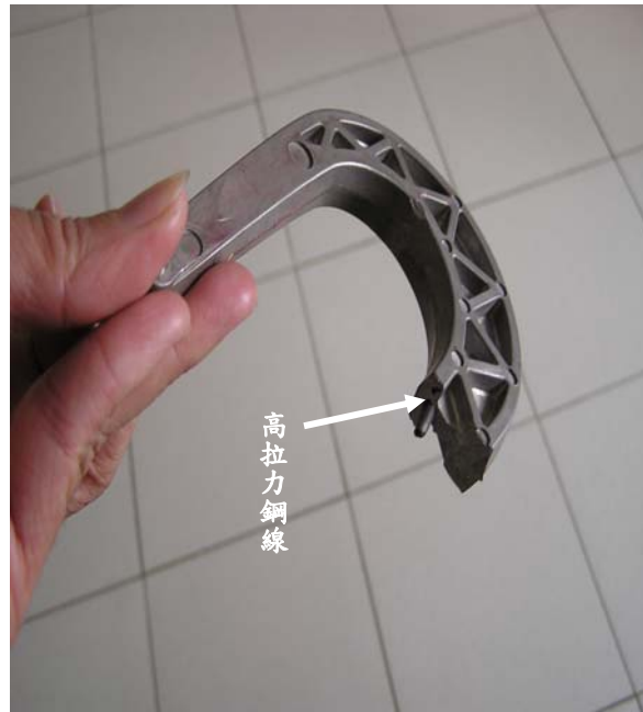
圖 6 吊鈎本體包覆高拉力鋼線
