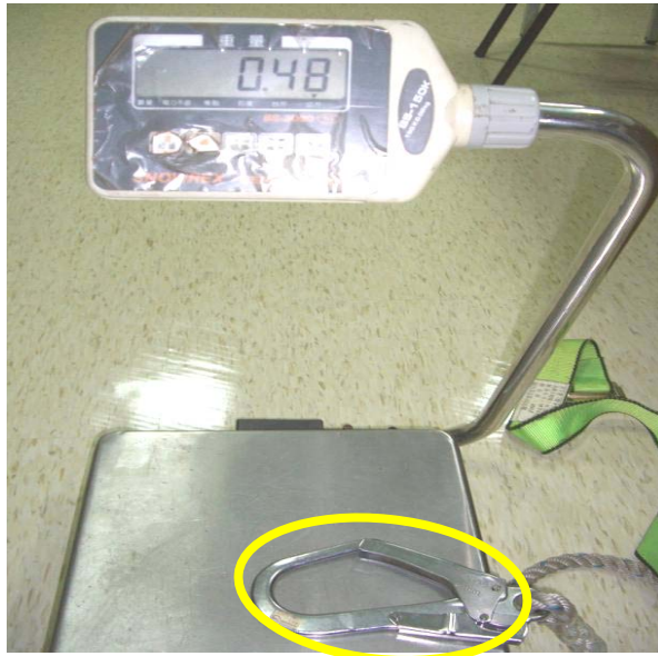
圖 3 電鍍軋鋼掛鈎重量
