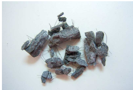
圖 12 1056/s 應變速率之破壞情形(1%)
