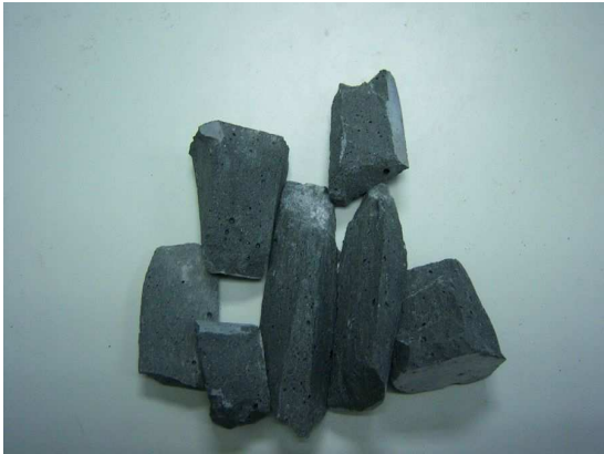
圖3 RPC纖維含量0%破壞情形
