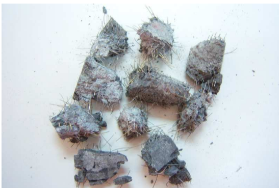
圖 13 1039/s 應變速率之破壞情形(2%)
