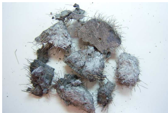
圖 14 978/s 應變速率之破壞情形(3%)
