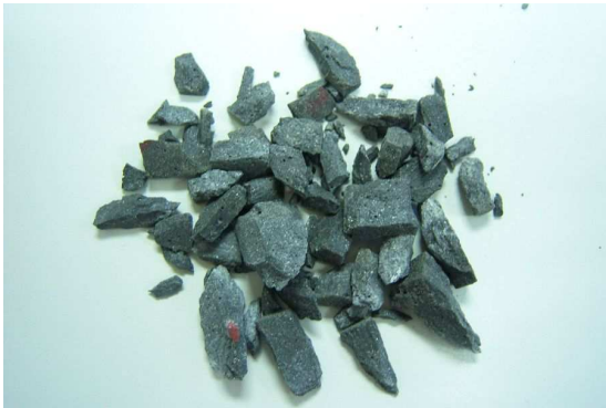
圖 11 877/s 應變速率之破壞情形(0%)
