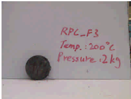
圖 3. RPCF3-T200-P2 破壞情形
