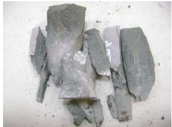
圖 7 鋼纖維含量 0% 之 RPC 破壞情形
