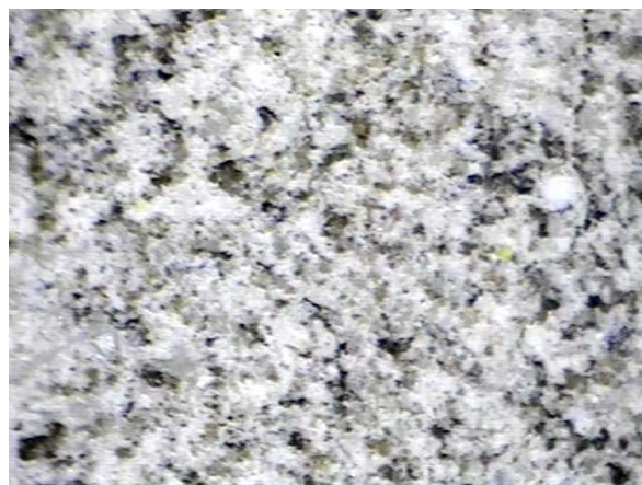
圖2 混合後壓製前PZT矽灰水泥粉末(300倍)
