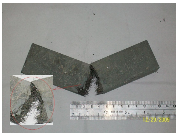
圖 13 RPC-2-靜態抗彎試驗後 試體斷裂情形
