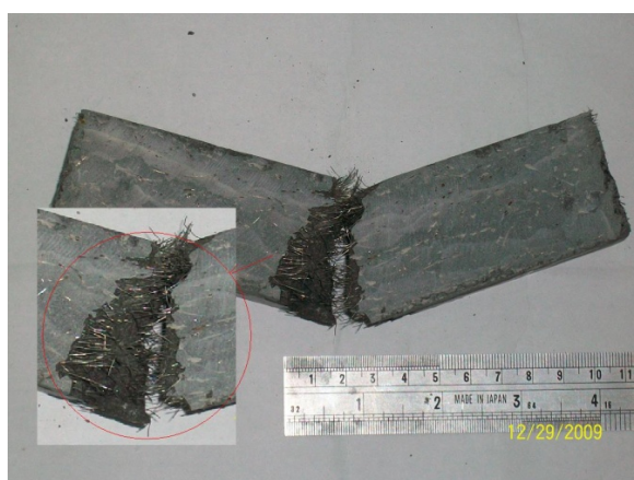
圖 14 RPC-F3-靜態抗彎試驗後 試體斷裂情形
