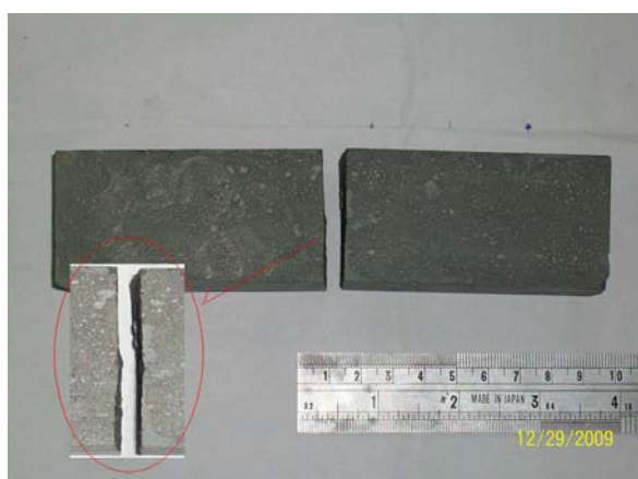
圖 11 RPC-F0-靜態抗彎試驗後 試體斷裂情形
