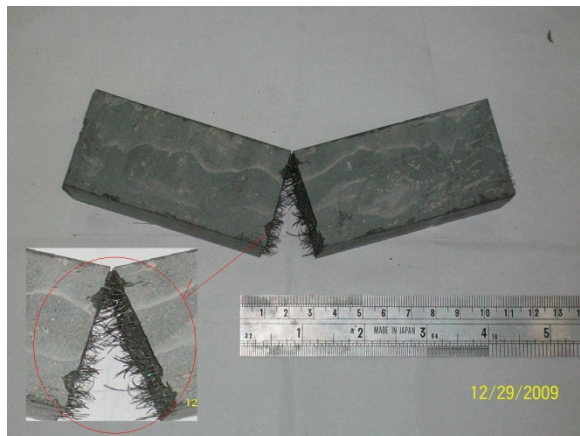
圖 12 RPC-F1-靜態抗彎試驗後 試體斷裂情形
