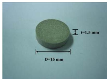
圖 4 壓製試體 (D = 15 mm, t = 1.5 mm)
