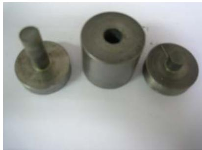
圖 3 壓製試體模
