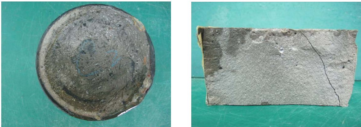
圖7 活性粉混凝土透水試驗滲透水滲入情形
