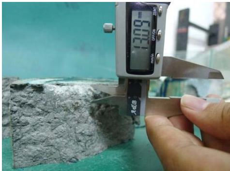
圖3 量測試體滲透深度
