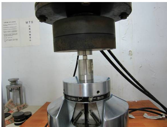
圖1 0-3型水泥壓電複合材料的壓製過程
