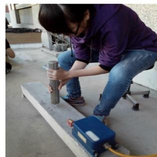
圖 4 阻尼比試驗：敲擊矩形梁
