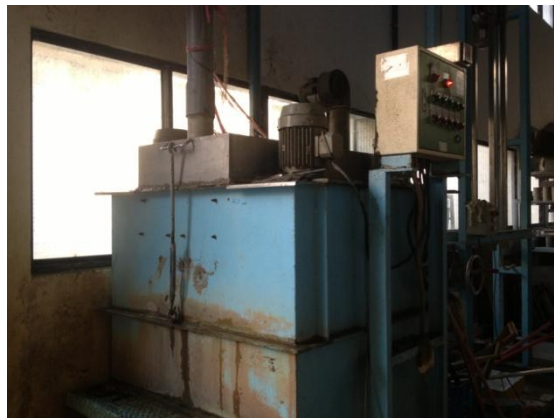
圖 2 含砂水流磨耗試驗的主體儀器
