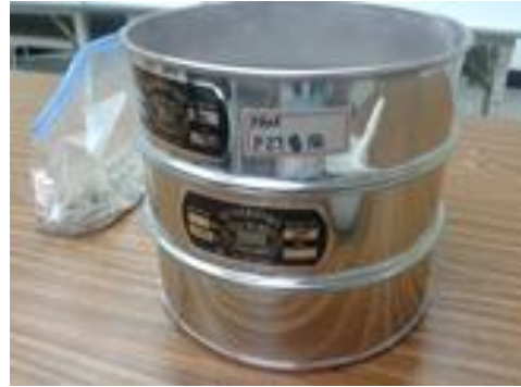
圖 2 標準篩控制 PZT 顆粒
