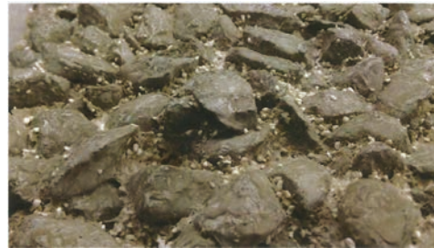
圖 8 多喝水混凝土
