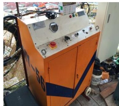
圖 3-5 油壓設備控制器
