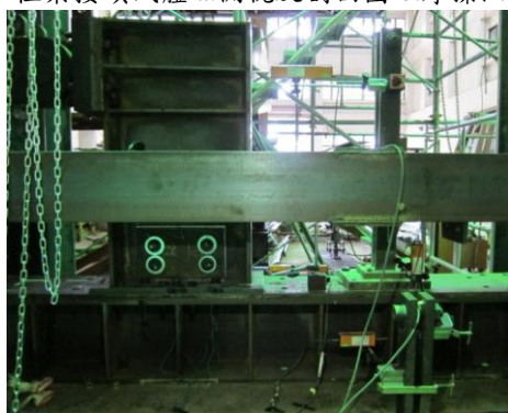
圖 10 柱梁接頭試體照片
