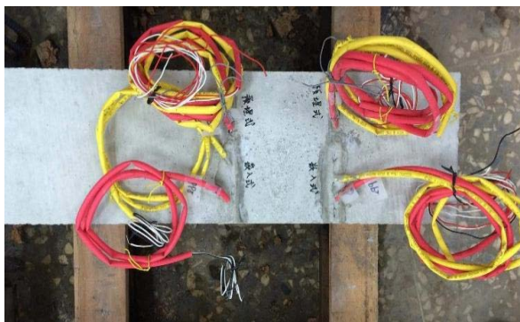
圖2 壓電水泥嵌入混凝土構件
