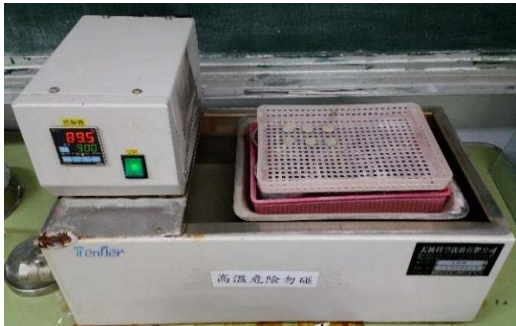
圖4 試體於恆溫循環水槽養護
