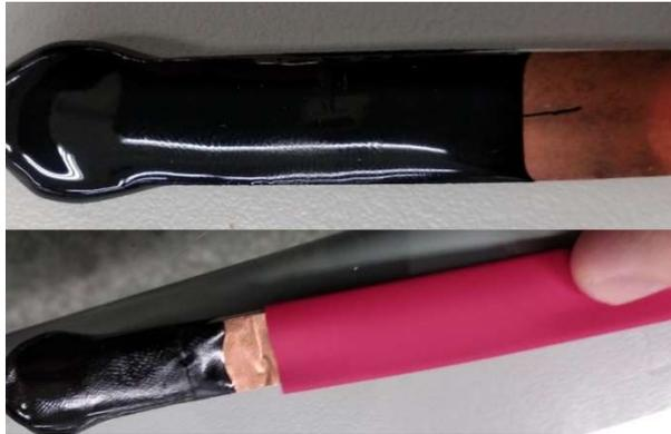
圖 1 感測器瀝青封裝及套入熱縮套管
