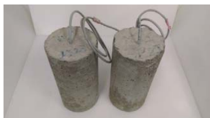
圖 6 混凝土試體埋設壓電感測器
