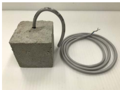
圖 5 水泥砂漿試體埋設壓電感測器
