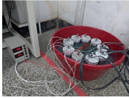
圖7 加速腐蝕試驗照片
