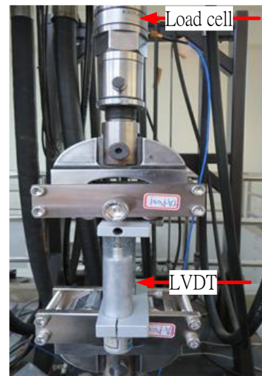
圖 3 直接拉伸架設實況
