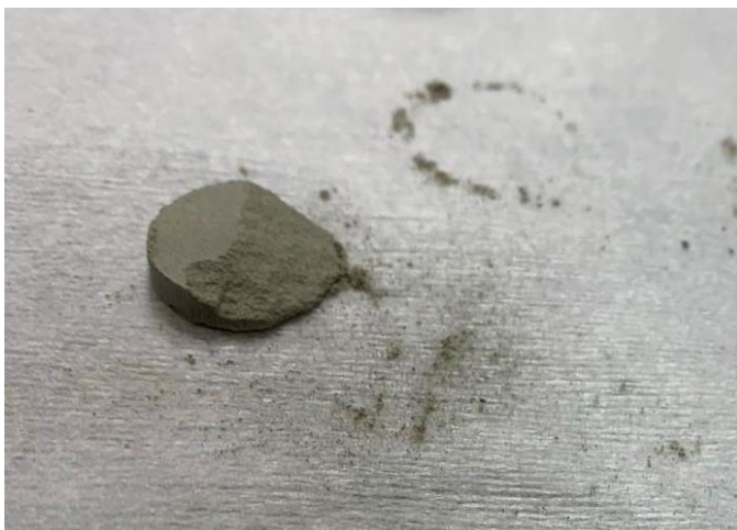
圖 3 壓製過程中碎裂試體
