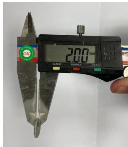
圖 4 研磨至設計厚度
