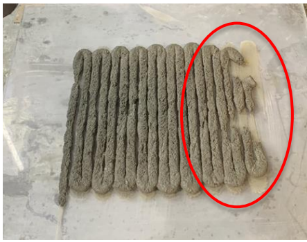
圖 3. t = 135 \text{ min} 連續擠出列印外觀
