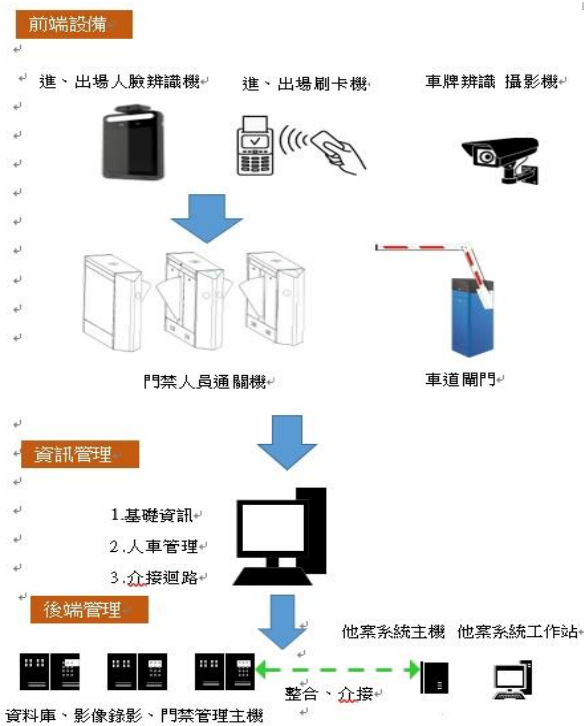
圖 4 門禁管制-前端設備、資訊及後端管理
