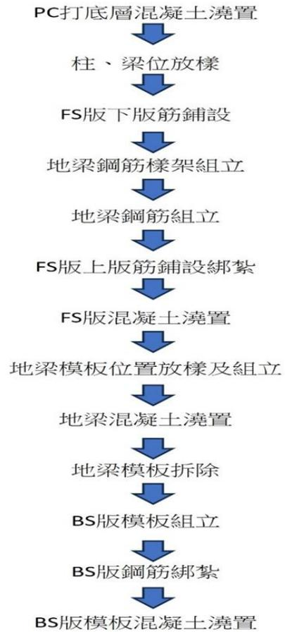
圖 14. 筏基工程作業流程拆解
